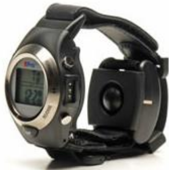
Figuur 30b: De BPPro manchetloze bloeddrukmeter van HealthSTATS International (Bron: HealthSTATS International)
