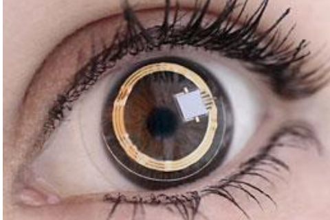
Figuur 35a: De Triggerfish contactlens die ontwikkeld wordt door de firma Sensimed om de oogdruk te meten (Bron: Sensimed)
