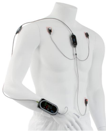
Figuur 28: Het meten van vitale functies, zoals ademhaling, bloeddruk, ECG en temperatuur met ViSi Mobile System van Sotera Wireless (Bron: Sotera Wireless)
