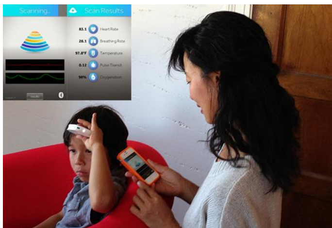
Figuur 29: Meten van de hart- en ademfrequentie, huidtemperatuur, pulse transit time , en SpO 2 met de Scanadu Scout (Bron: Scanadu)
