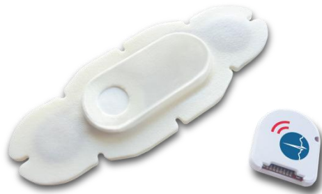
Figuur 30a: De HealthPachMD, een pleister waarin een chip wordt geplaatst en die o.a. het ECG registreert (Bron: Vitalconnect).
